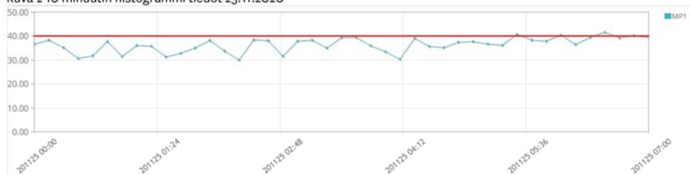
Kuva 3 Mittausjakson 00:00-7:00 histogrammitulokset verrattuna yöohjearvoon LAeq 40dB, tulokset alittavat ohjearvon.
