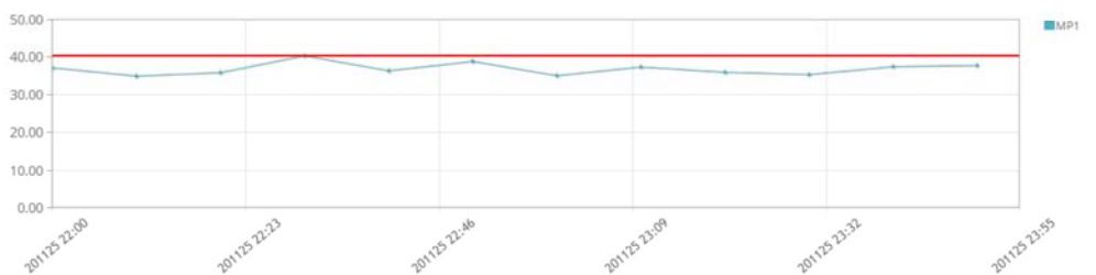
Kuva 4 Mittausjakson 22:00-23:50 histogrammitulokset verrattuna yöohjearvoon LAeq 40dB, tulokset alittavat ohjearvon.
